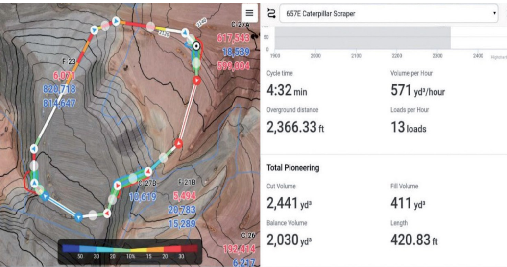
Рисунок 19 – Цифровая модель траектории движения скрепера
