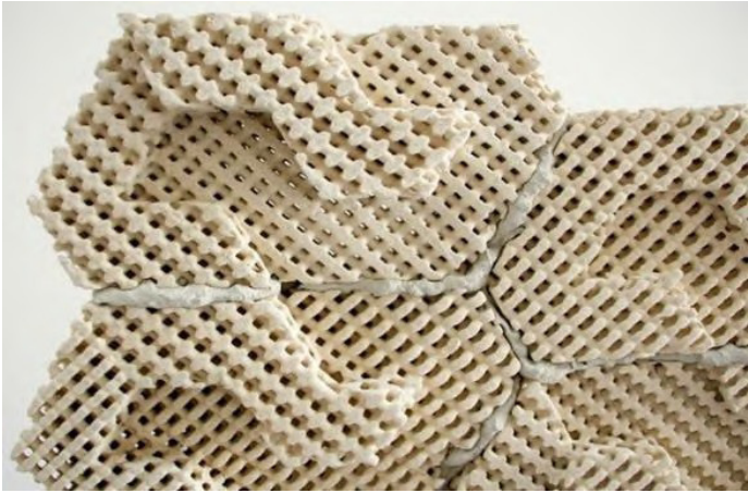
Рисунок 44 – Энергоэффективный 3D-напечатанный кирпич с охлаждением
