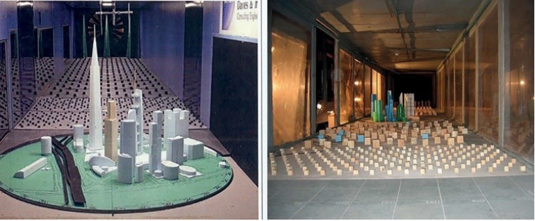
Рисунок 20 – Макет комплекса ММДЦ «Москва-Сити» в аэродинамической трубе
