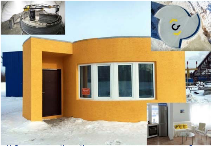
Рисунок 29 – Жилой дом российской компании Aris Cor, созданный при помощи 3D – принтера
