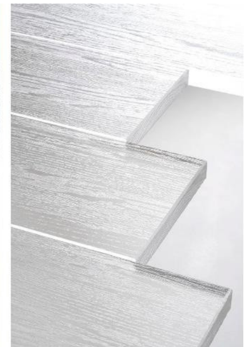
Рисунок 49 - Примеры прозрачной древесины и варианты ее использования в архитектуре
