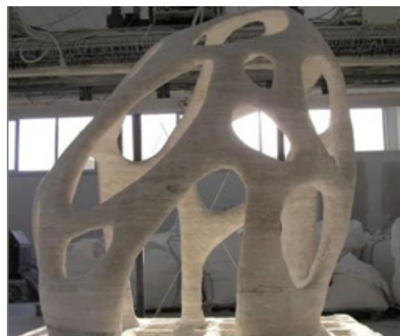
Рисунок 36 - Первая крупноформатная геометрически сложная скульптура, напечатанная на 3D-принтере D-Shape 1
