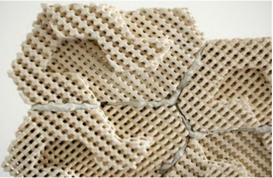
Рисунок 39 – Современный стройматериал - 3D-напечатанный кирпич с охлаждением [18]
